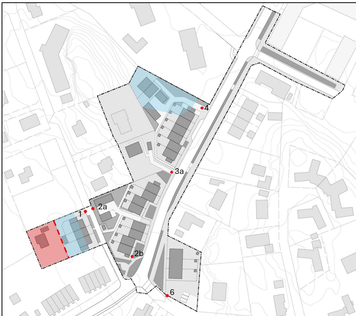
Figur 10-7. Översikt visande lägesförslag för nya förbindelsepunkter (röda punkter) för kvartersmark samt för vilket planerat tekniskt delavrinningsområde anslutningen avser. Röd-streckad linje och röd skraffering markerar den del av delområde 1 som inte bedöms kunna anslutas till förbindelsepunkt 1 med självfall. Blå skraffering markerar ytor som bedöms fordra ytliga/grunda dagvattenanordningar. (Bearbetad från: Landskapslaget, 2025-11-14)
