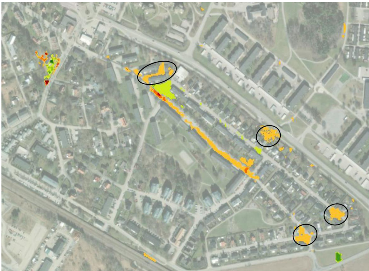
Figur 29 Ytor som väntas få 2-4 som högre vatten om planförslaget genomförs, utan ytterligare åtgärder eller om Bro Torg inte genomförs.
