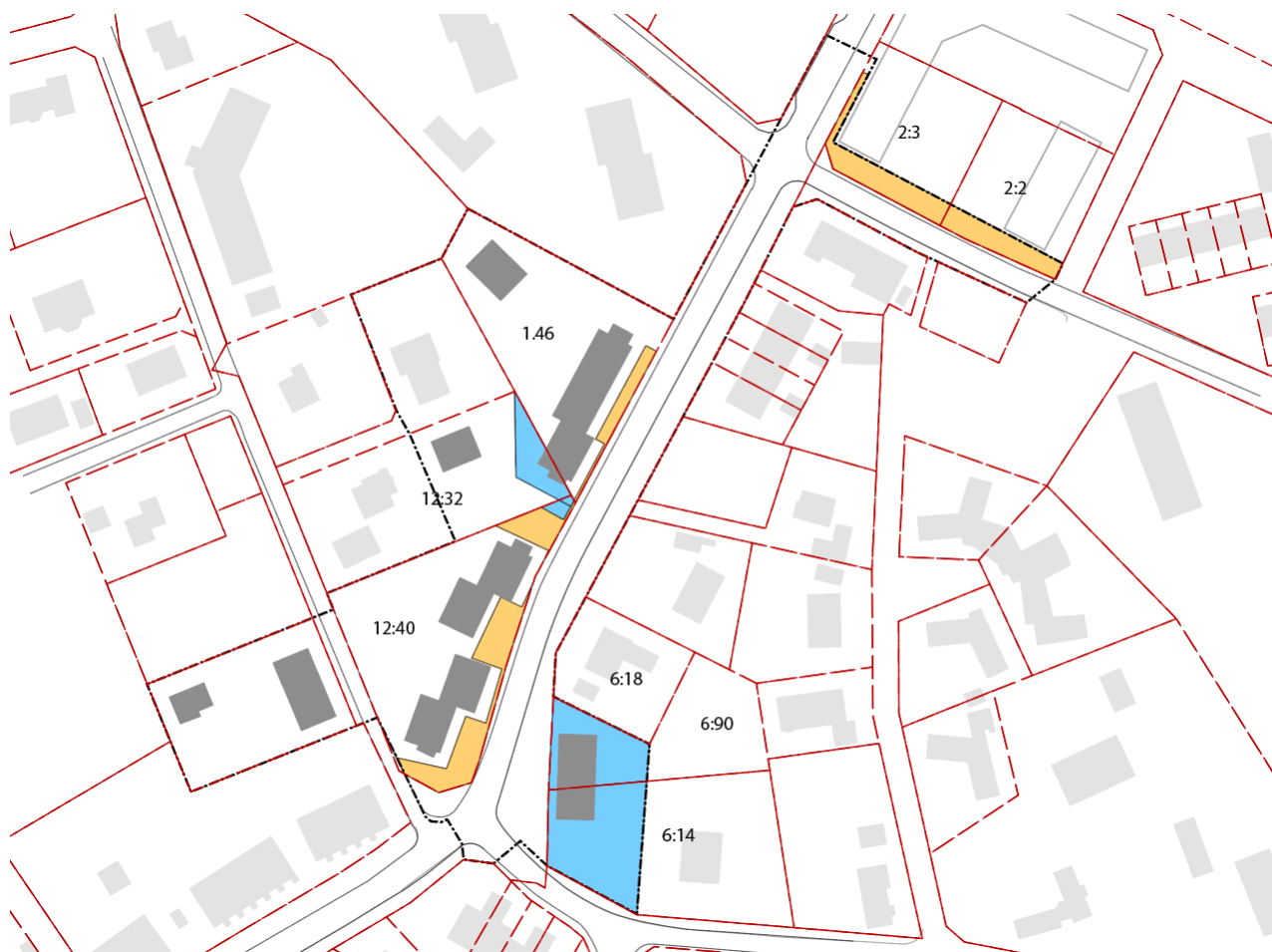
Figur 30. Karta som visar förändringar i markanvändning och reglering av fastigheter. Gula ytor visar på kvartersmark som överförs till allmän plats, GATA & PARK. Blå ytor visar på fastighetsregleringar, överföring från en fastighet till en annan på kvartersmark.
