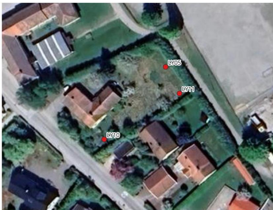
Figur 28 - Borrpunkter där grundvattenrör installerats inom undersökningsområdet enligt det geotekniska borrprogrammet. (figur 7, Intec 2026)
