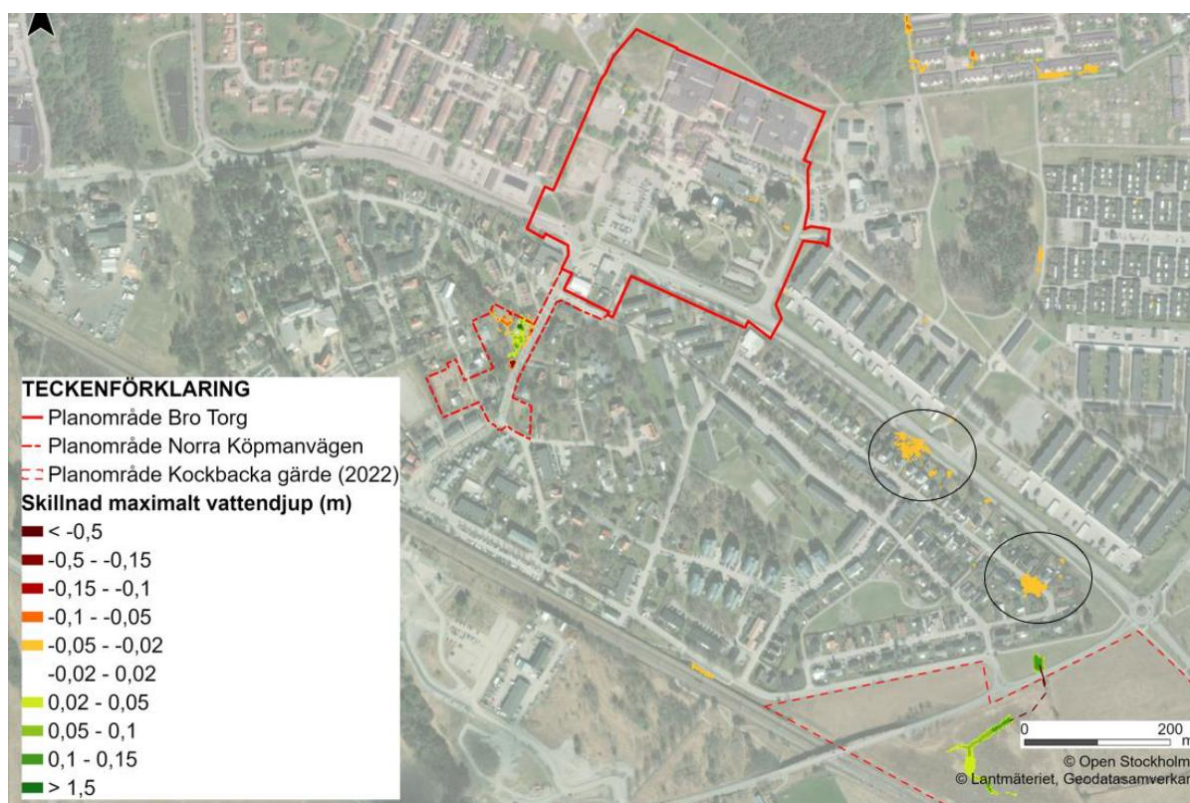
Figur 32. Skillnadskarta som jämför förändring mellan nuläge och genomförande av planförslaget, om inte Bro torg genomförs eller andra åtgärder vidtas. Ytor som väntas få 2-4 cm högre vatten om planförslaget är inringade. (bild, Sweco)
