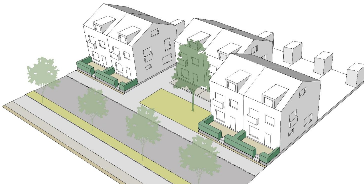
Figur 14. Axonometri som illustrerar princip för utformning av förgårdsmark. Närmast gatan utförs förgårdsmark lätt upphöjd, avgränsad med låg häck. Mot indragen plats ges förgårdsmarken en mer öppen karaktär.
