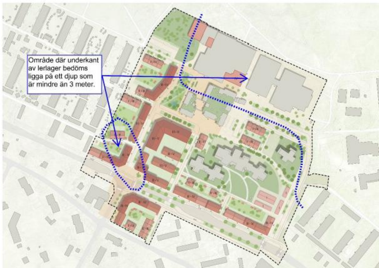
Strukturplan med områden för tolkat djup till underkant av lerlager. Blå streckade linjer markerar gränser för djupet 3 meter från befintlig markyta till underkant av befintligt lerlager, tolkat utifrån utförda geotekniska undersökningar. Sweco 2026.
