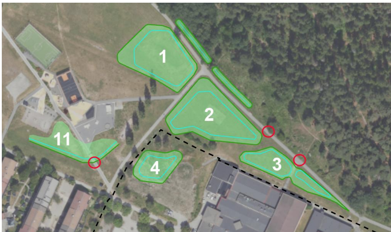
En sammanställning av de planerade åtgärderna i Stjärnparken. Gröna ytor är fördröjningsytor och diken där blått inringat område avser översvämningszon och röda inringade punkter är punkter avser lägen där gång- och cykelbanan behöver höjdsättas annorlunda för att blockera eller styra vattnet till avsedda lågpunkter.
