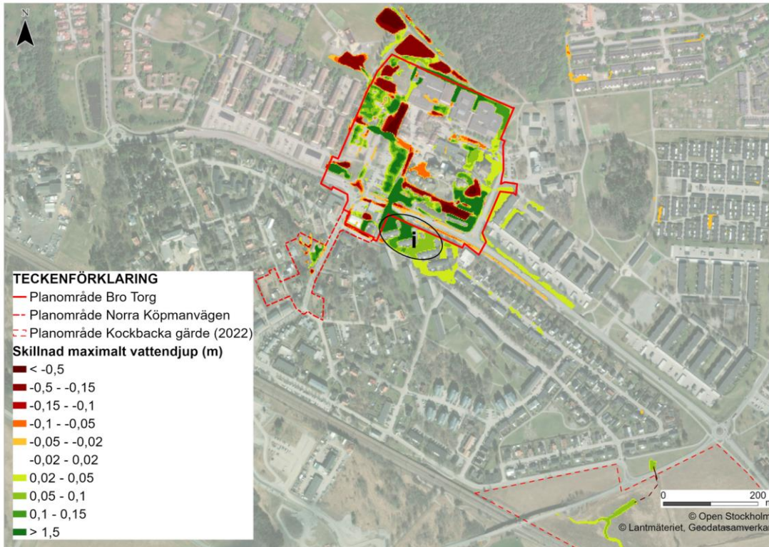
Figur 3. Skillnader i maximala vattendjup vid 100-årsregn med klimatfaktor 1,4 i Scenario 2 med Scenario 0. Röda och orangea färger visar en försämring medan gröna färger indikerar en förbättring. Förändringar +/- 0,02 m visas ej.
