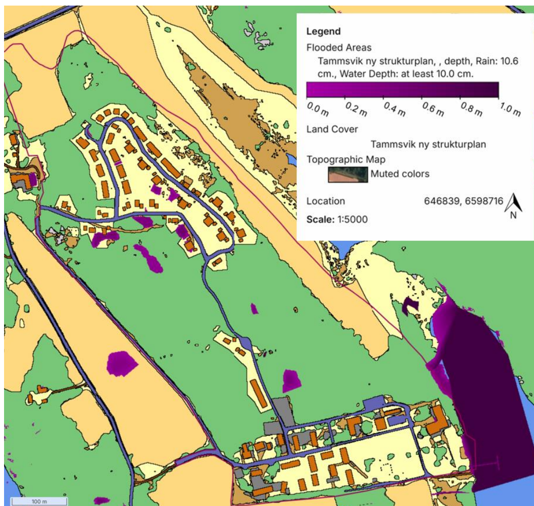
Figur 7-4. Skyfallskartering vid 100-årsregn motsvarande 106 millimeter regn inom och omkring utredningsområdet. Kartan visar den planerade markanvändningen.
