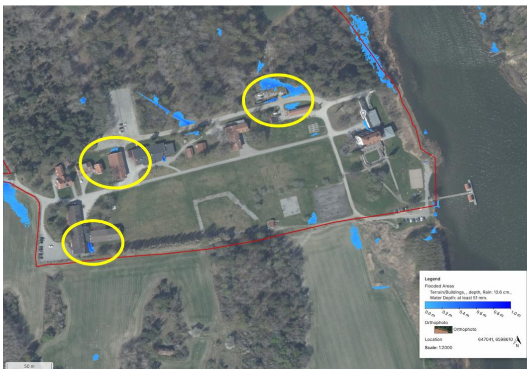
Figur 7-3. Lågpunkter kring den befintliga bebyggelsen inom södra delen av utredningsområdet. Riskområden är markerade med gula cirklar. Figur framtagen av AFRY.
