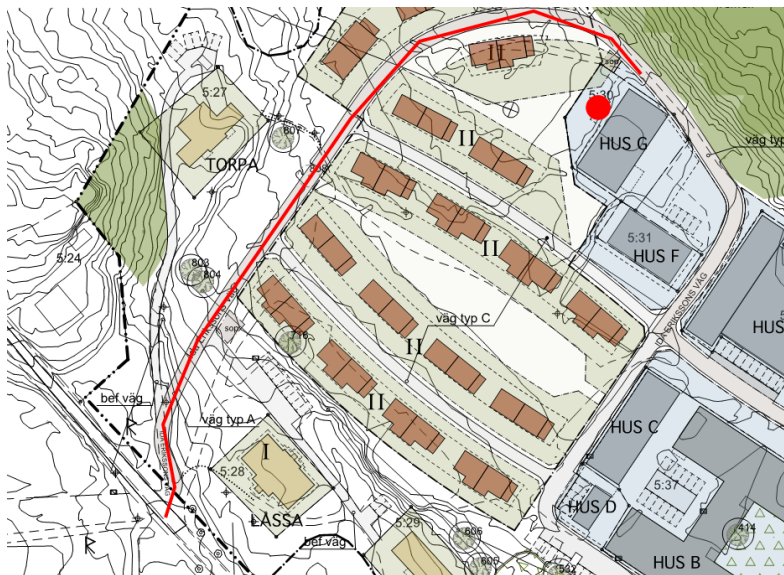
Figur 1. Förväntad körväg för transport av gasol till mikrobryggeri i hus G. Gasoltank är markerad med röd cirkel.
