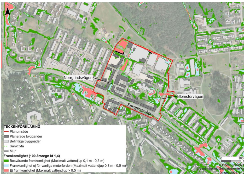
Figur 3.11. Framkomlighet i och omkring planområdet i framtida situation med planerade åtgärder.
