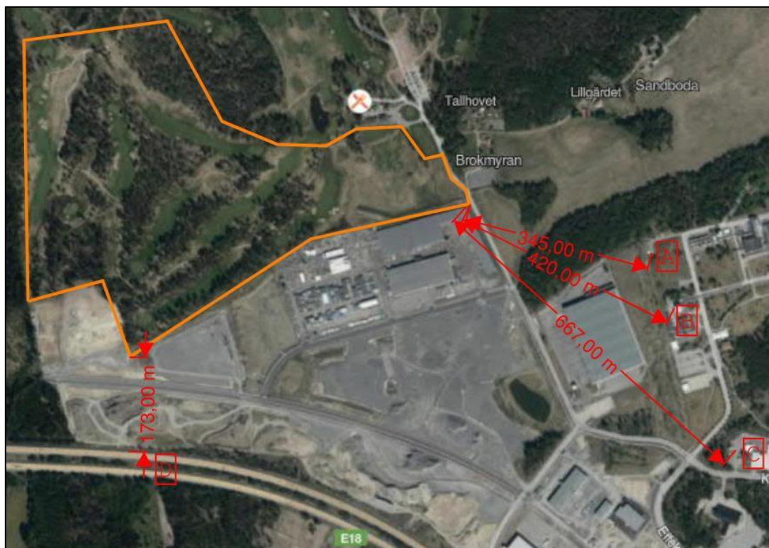
Figur 5.23 Områdeskarta med planområde utritat i orange och avstånd till närmaste riskkällor. A = Yttre gräns Fresenius Kabis område. B = Närmaste anläggningsdel Fresenius Kabis. C = Yttre gräns Air Liquide. D = E18. Bild från riskinventeringen (Tyréns, 2020).
