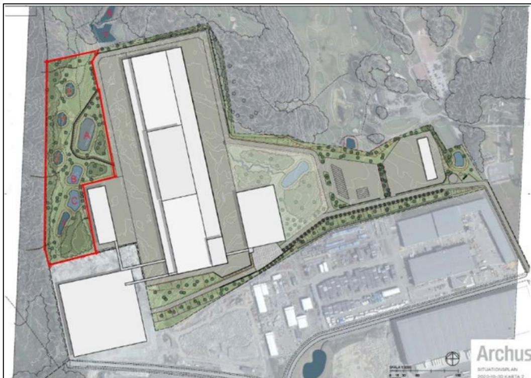
Figur 5.9 Översiktlig skiss av planområdet med reningsdammar för dagvatten (A) och sedimentationsdammar (B och C), befintliga salamanderdammar (1, 7, 8) samt nya salamanderdammar (X, Y och Z). Reningsdammen är avskild mot naturområdet med barriär. Bild från gestaltungsprogrammet (Archus Arkitekter, 2020).
