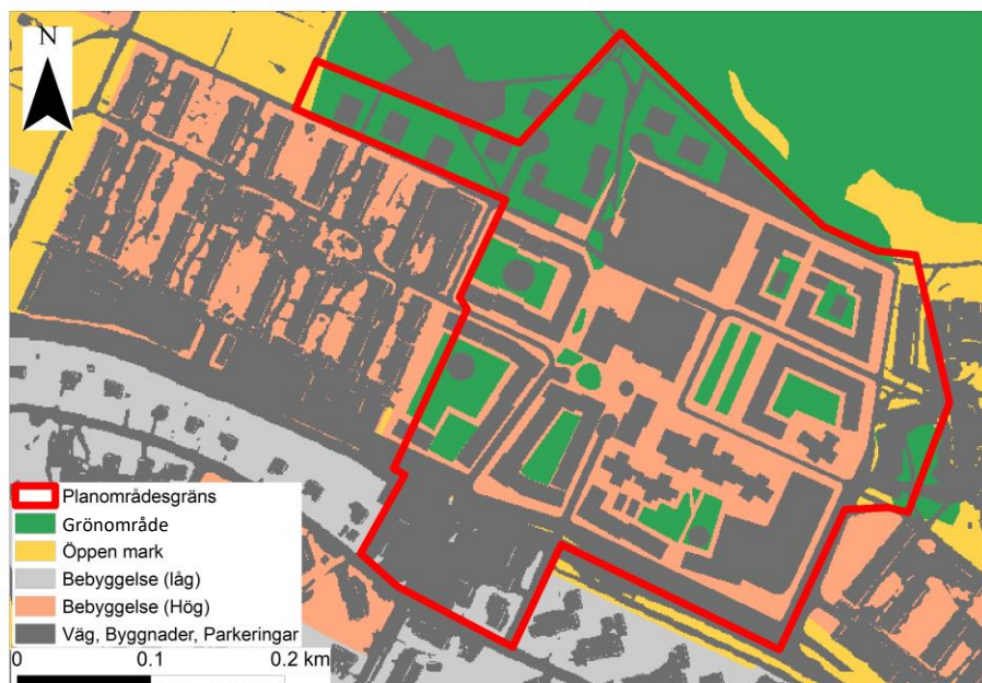
Figur 8 Fördelning av Mannings tal för framtida situation.
