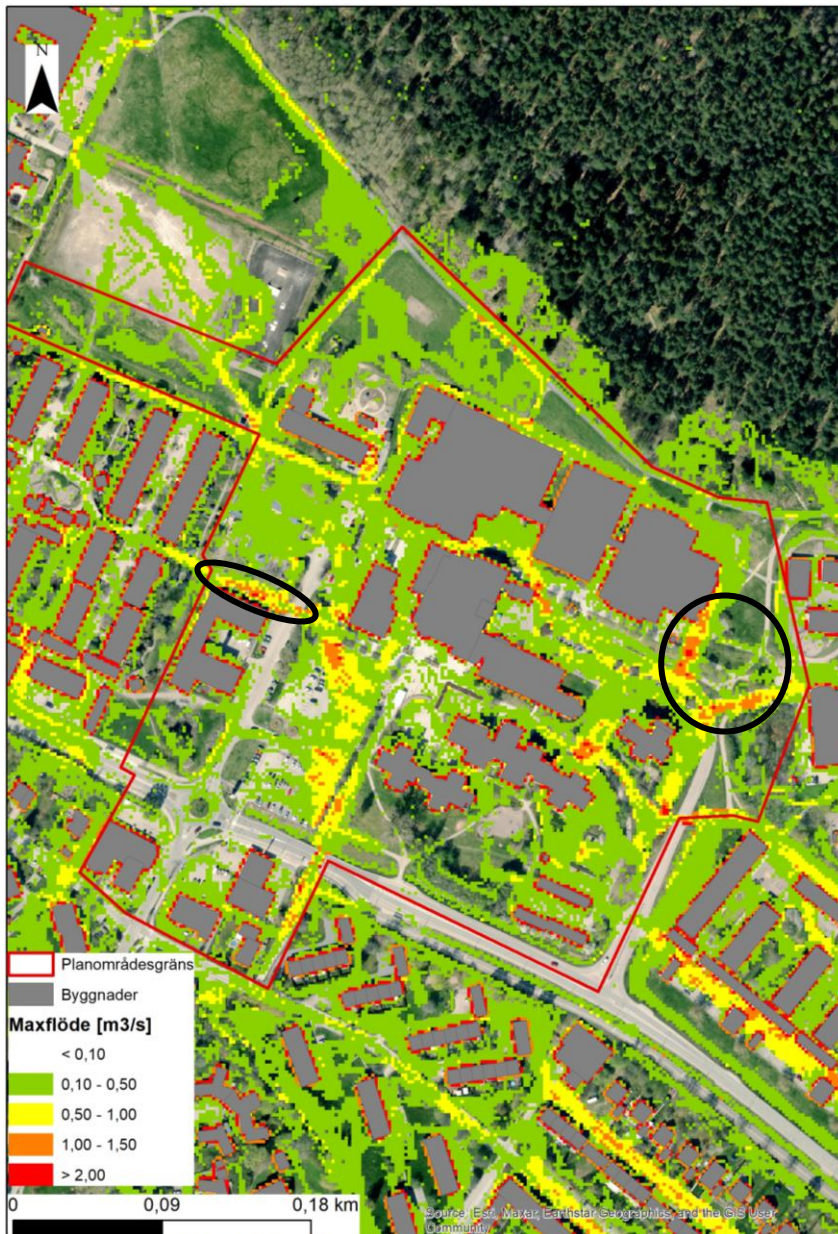
Figur 12 Maxflöde för befintlig situation inom planområdet. Svarta ringar visar vattenflöde över 1,50 m³/s.
