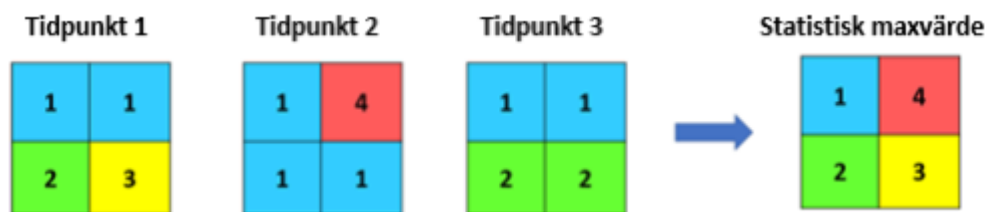
Figur 10 Princip för hur statistiskt maxvärde bestäms under modellsimulering.
