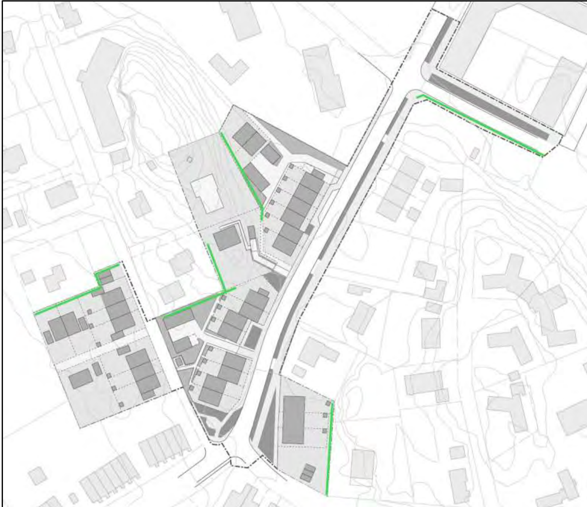
Figur 10-15. Översikt visande förslag på placering av avskärande diken (grön) för avledning av diffus tillrinning. (Bearbetad från: Landskapslaget, 2025-05-16)
