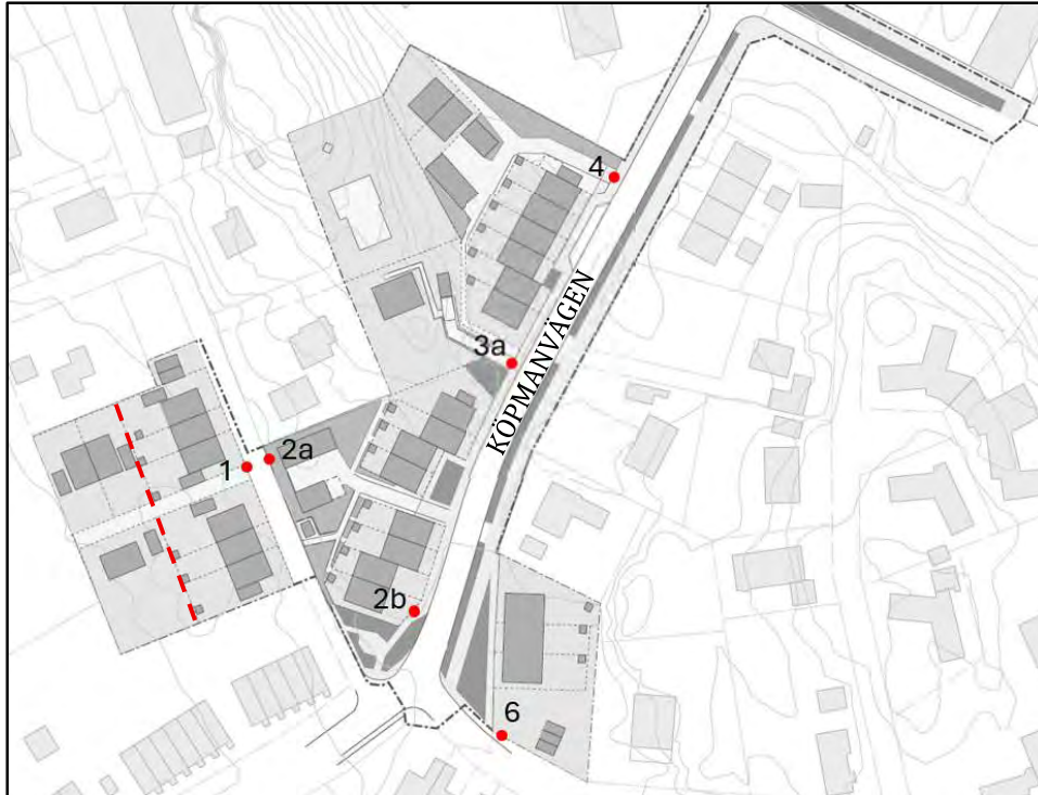
Figur 10-7. Översikt visande lägesförslag för nya förbindelsepunkter (röda punkter) för kvartersmark samt vilket planerat tekniskt delavrinningsområde anslutningen avser. Röd-streckad linje illustrerar beskriven självfallsbegränsning inom delområde 1. (Bearbetad från: Landskapslaget, 2025-05-16)
