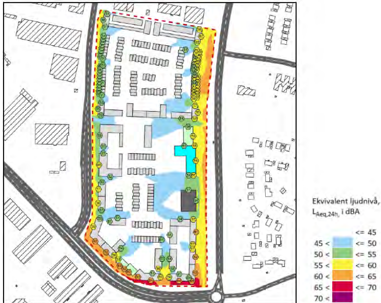
Beräknade ekvivalenta ljudnivåer från trafik, prognosår 2040 med ny exploatering. Frifältsvärden vid fasadmarkörer, 1,5 m över mark i dBA (Akustikkonsulten, 2020).
